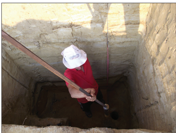
Рис. 3. Меджибізький нижньопалеолітичний мікро-регіон (Хмельницький р-н та обл.), розвідки на палеоліт, 2016 р., шурф 2, геолог С. Кармазиненко досліджує нижню частину шурфу забивним стаканом
