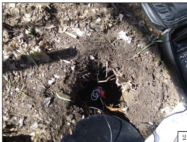
Рис. 2. Розвідувальне буріння на палеолітичному місцезнаходженні Наплавна Дача, 2014 р. (Станично-Луганський р-н, Луганська обл.). 1 — обладнання для фото та відео зйомки в свердловині; 2 — відеокамера у свердловині
