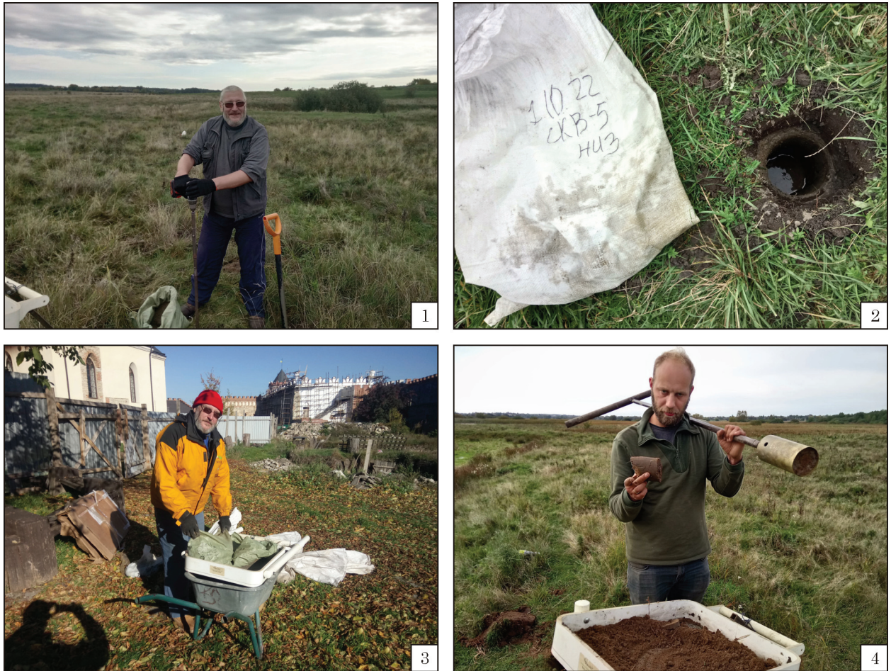
Рис. 6. Буріння розвідувальних свердловин модифікованим обладнанням: 1 — ручний бур з електроприводом; 2 — відбір кернів на промивку; 3 — промивка кернів на базі; 4 — Є. Поляченко на просіві кернів біля свердловини
